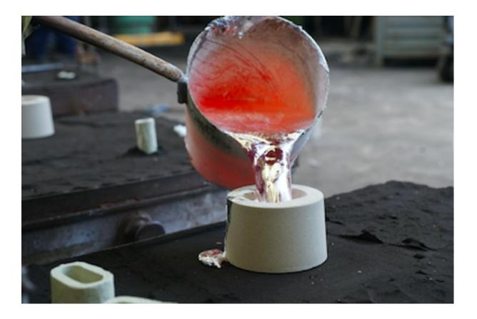
Sival Fonderie fabrique pour le secteur aéronautique et ferroviaire des pièces de haute technicité à base d'alliages d'aluminium.
